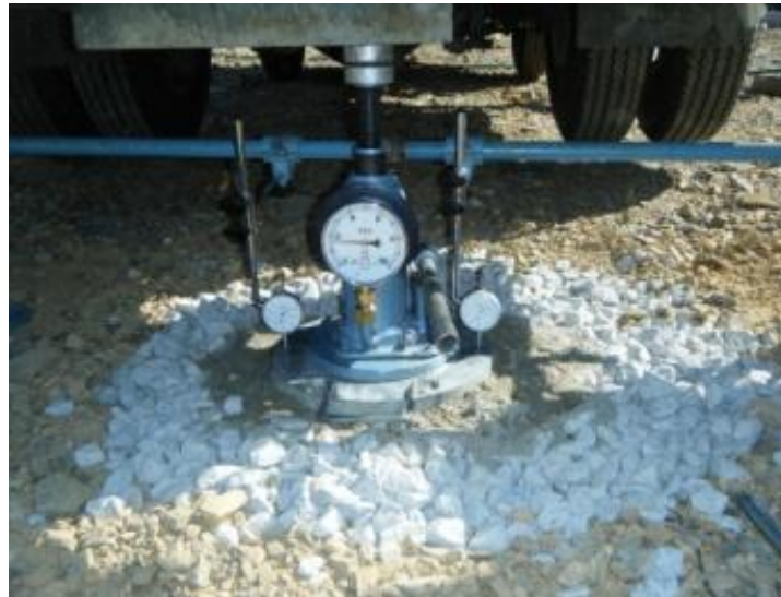
(平板載荷試験状況)
